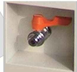
デフロスト後や清掃時のトラップ内のドレンを排出する際に開閉します。装置前面に装備しておりますので、開閉が容易です。
