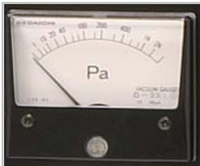
ピラニ式真空計を標準装備しております。乾燥中の真空度が正確に確認できます。昇華開始の真空度の変化等が分かります。
